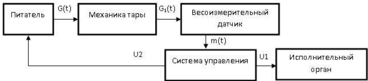
Рис. 1. Функциональная схема дозатора дискретного действия
