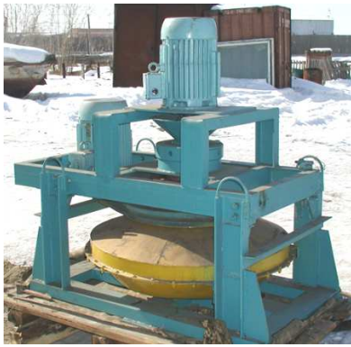
Рис. 1. Общий вид и основные конструктивные параметры опытного образца центробежной мельницы ступенчатой ЦМВУ-800
