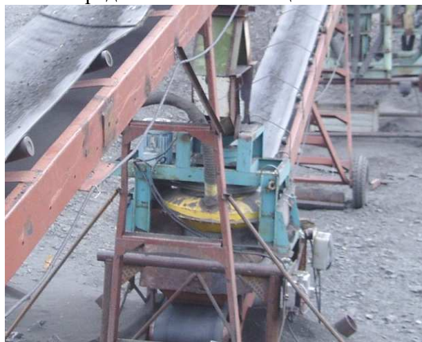
Рис. 4. Фрагмент работы центробежной мельницы ЦМВУ-800
