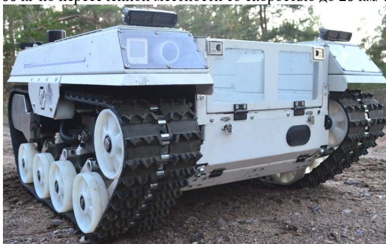
Рис. 1. Опытный образец мобильной гусеничной робототехнической платформы «Объект 314»
