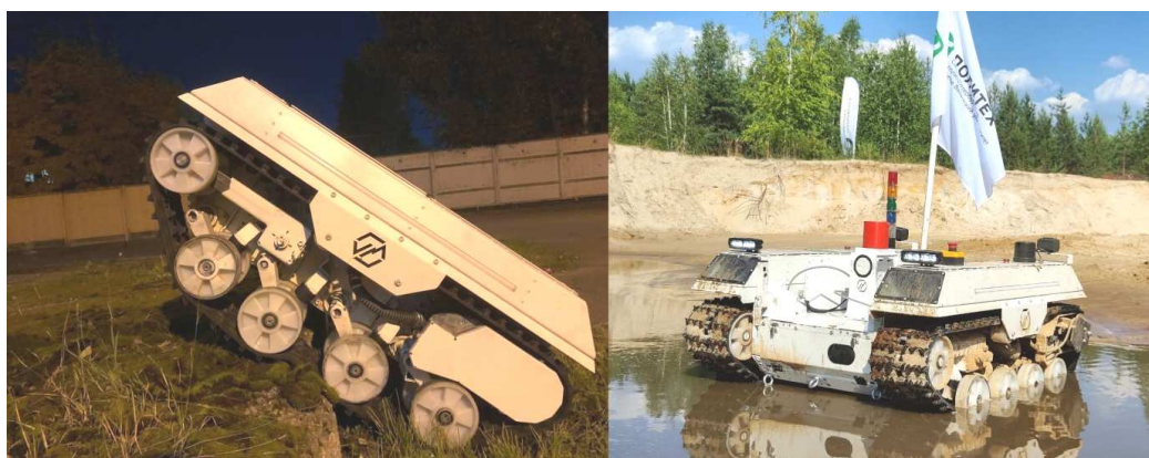
Рис. 5. Преодоление вертикальной стенки (слева) и брода (справа)
