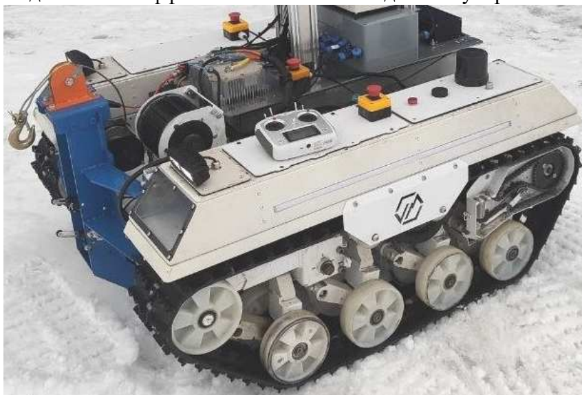
Рис. 6. Платформа «Объект 314» после модернизации для уборки снега; над балансирами хорошо видны ограничители хода; модули для уборки снега не установлены
