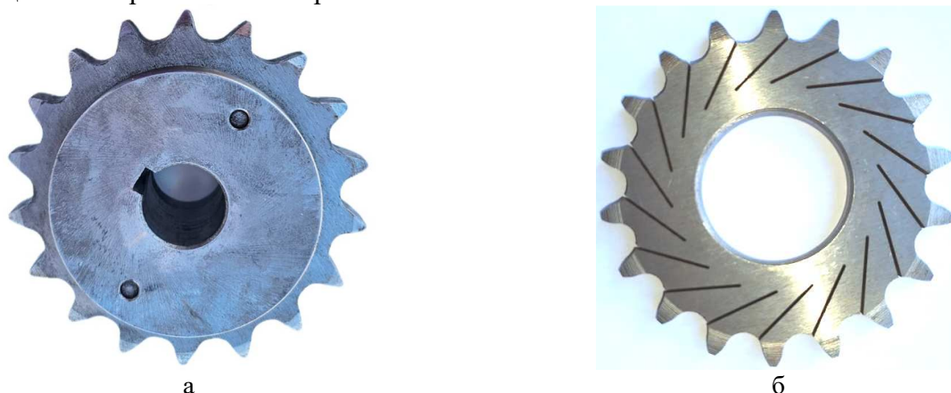
Рис. 11. Звездочки с модифицированными зубьями: а – с несимметричными зубьями; б – с консольными зубьями
