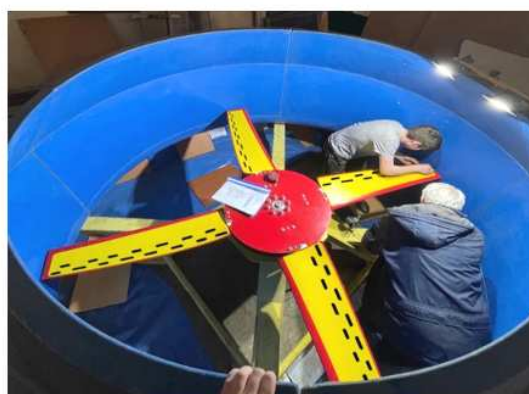
Рис. 3. Аэродинамическая характеристика вентиляторной установки ВУ 2,5-1,8К4 (а); вентиляторная установка ВУ 2,5-1,8К4 на стенде для аэродинамических испытаний (б)
