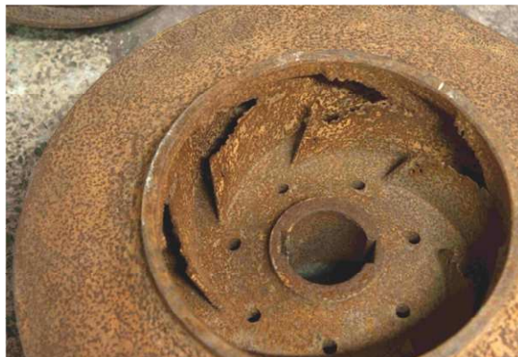
Рис. 2. Эффект коррозии рабочего колеса насоса
