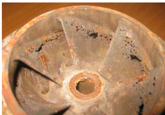
Рис. 1. Эффект кавитации на кромке лопасти рабочего колеса насоса
