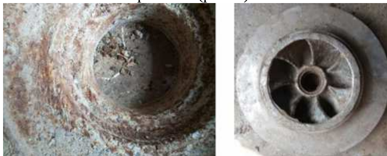
Рис. 3. Эффект эрозии корпуса и рабочего колеса насоса
