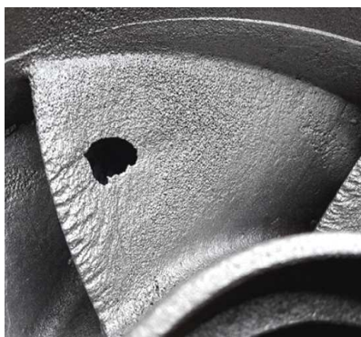
Рис. 1. Эффект кавитации на кромке лопасти рабочего колеса насоса
