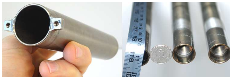
Рис. 3. Колба из титанового сплава для детекторов низкоэнергетического гамма-излучения (слева) и колбы с малым наружным диаметром, но большой длиной, рассчитанные на внешнее давление 138 МПа – с большим соотношением диаметра к длине – наружный диаметр 1 дюйм (25,4 мм), длина 118,5 дюйма (3010 мм) (источник: National K Works, Inc.)
