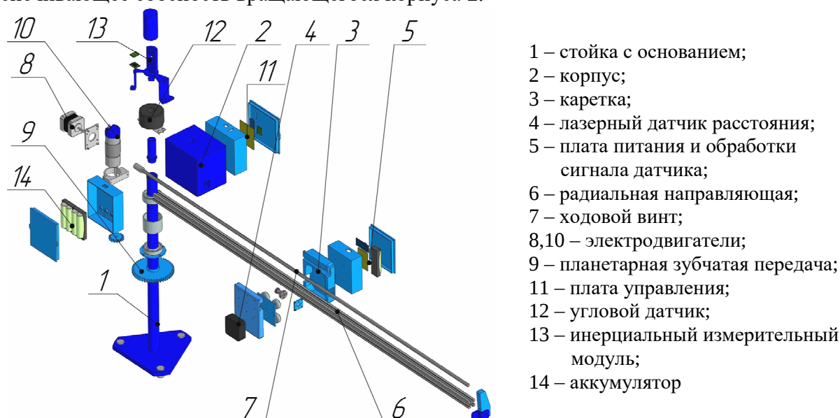
Рис. 1. Конструктивно-кинематическая схема профилографа
