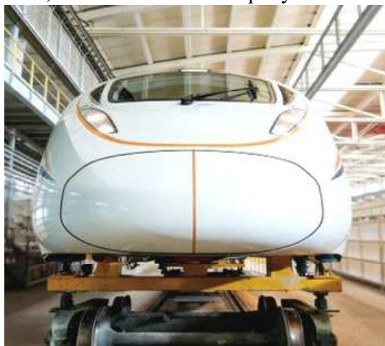
Рис. 4. Применение спроектированного опорного устройства для транспортировочной тележки вагонов метрополитена
