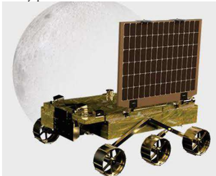
Рис. 1. Индийский луноход Pragyan на шасси с подвеской «коромысло-качалка»
