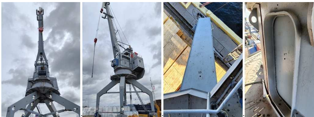
Рис. 3. Точки измерения толщины металла ног портала
