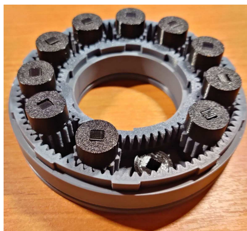
Рис. 4. Бессепараторный подшипник с зубчатым зацеплением в процессе сборки
