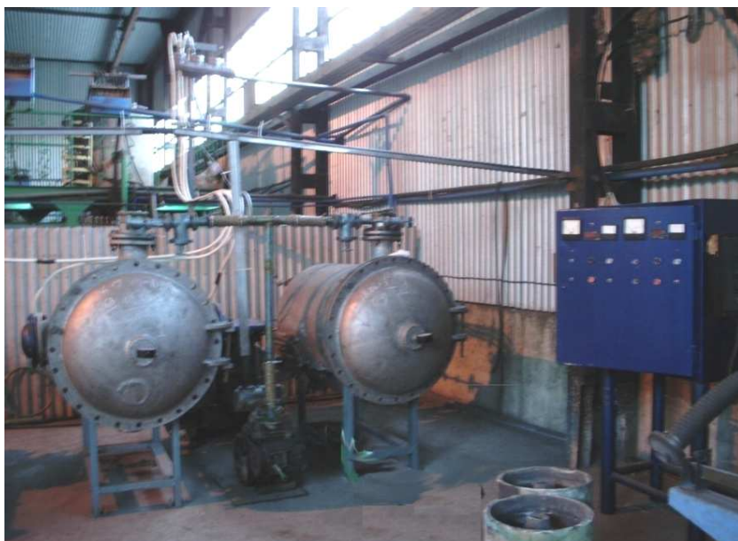
Рис. 2. Лабораторная модель печи деструкции кальцита
