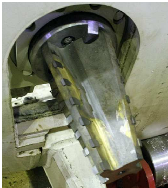
Рис. 7. Законтурный ИО типа фреза с возможностью поперечного перемещения в законтурном канале
