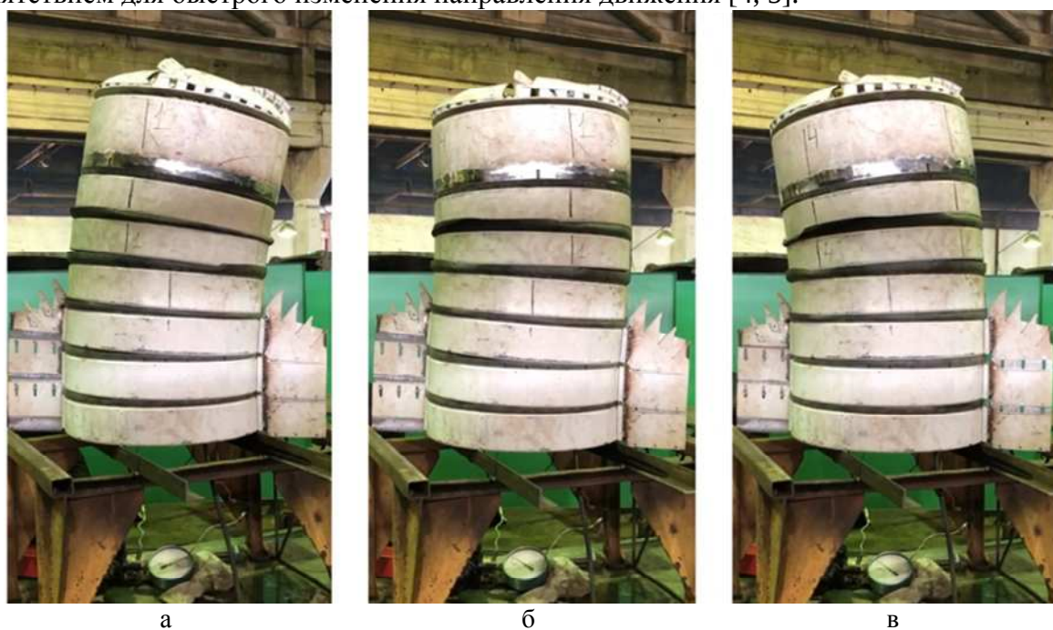
Рис. 5. Демонстрация гибкого тела а) крайнее положение «поворот вправо», все сочленения в крайнем правом положении, б) промежуточное положение, изгиб верхнего сочленения в завершающей фазе, изгиб нижнего сочленения – в начальной фазе, в) крайнее положение «поворот влево», все сочленения в крайнем левом положении
