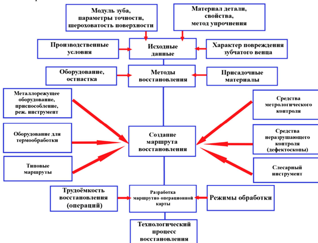
Рис. 1. Графическая модель формирования технологического процесса восстановления зубчатых колес
