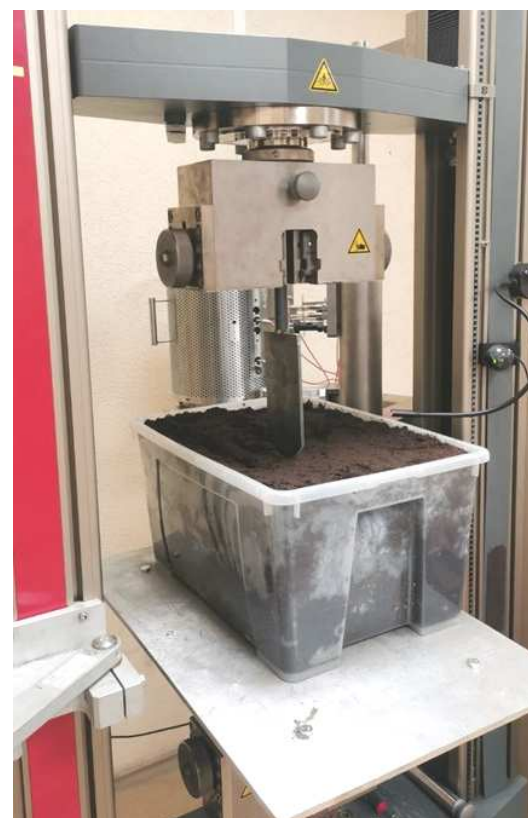
Рис. 2. Лабораторная установка для измерения усилия резания грунта
