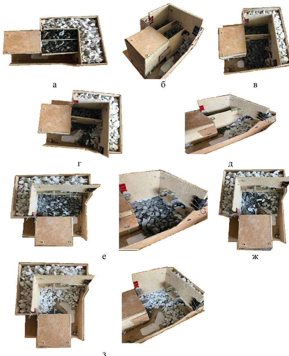
Рис. 3. Характерные этапы выпуска рудной массы при m_p = 5 м и \alpha = 5^\circ : а – готовая к выпуску модель; б – поднят угловой породный шибер на 5 см; в – начало выпуска 1 целика; г – 65 ковш 1 целика; д – окончание выпуска 1 целика, 86 ковш; е – начало выпуска 2 целика; ж – 49 ковш 2 целика; з – окончание выпуска 2 целика, 92 ковш
