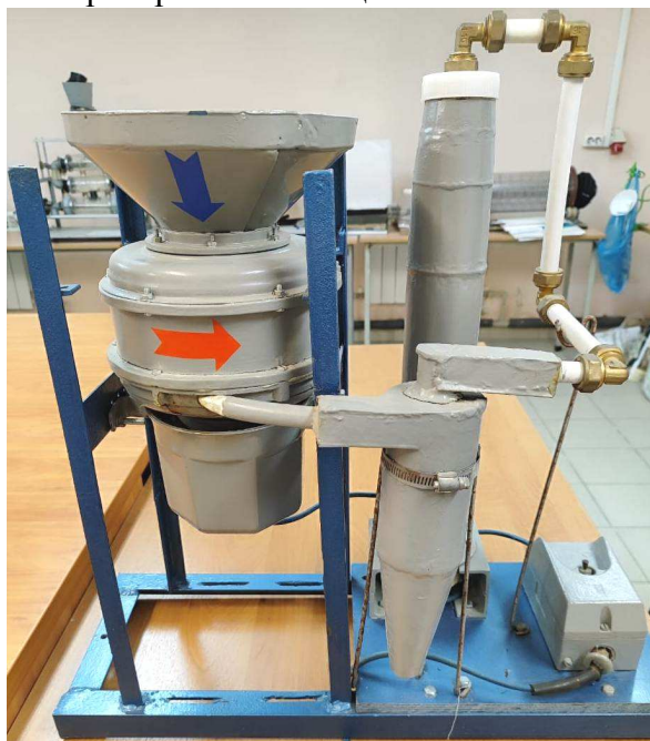
Рис. 1. Экспериментальная установка помольного комплекса с роторной мельницей оригинальной конструкции (составлено Т.Н. Ореховой)
