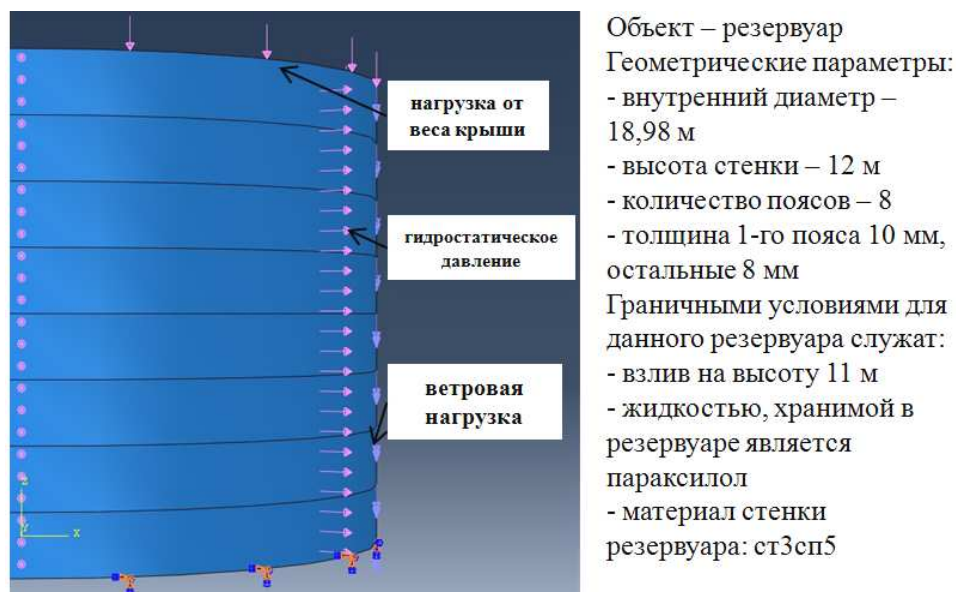
Рис. 1. Конечно-элементная модель резервуара
