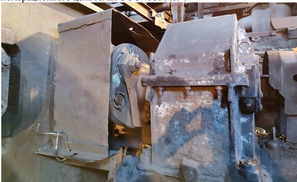
Рис. 3. Муфта пальцевая с эластичным элементом дискового типа в производственных условиях
