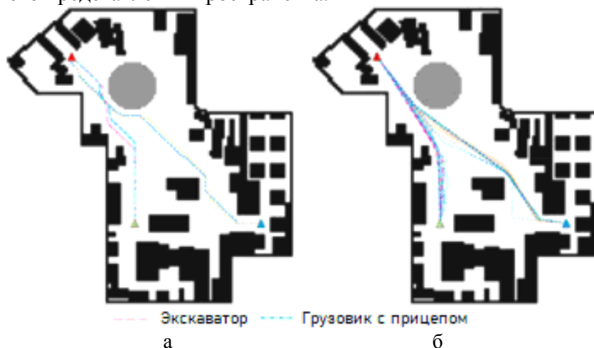
Рис. 3. Результаты сравнения двух алгоритмов: а) алгоритм A^* ; б) алгоритм глобального планирования (GA)
