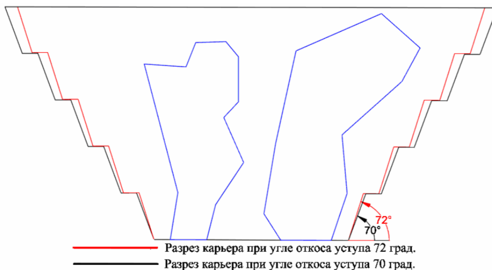
Рис. 5. Влияние угла откоса уступа на объем вскрышных пород в конечном контуре карьера
