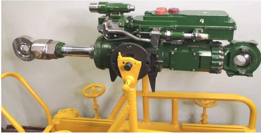
Рис. 3. Общий вид гидропривода
