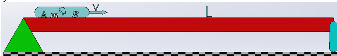
Рис. 1. Схема движения твердого тела по упругой балке, закрепленной на обоих концах
