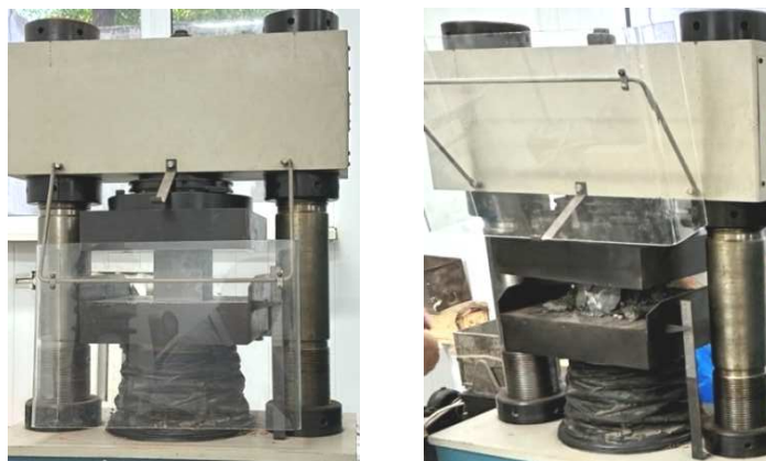
Рис. 3. Испытания образцов кубов на прессе ИП-1250-М Авто
