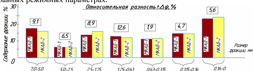
Рис. 11. Сопоставление гранулометрического состава измельченного мергеля мельницами «МКАД-1» и «МКАД-2»
