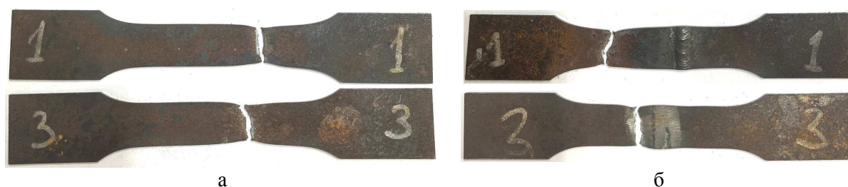
Рис. 7. Образцы после разрушения: а – без сварного шва; б – со сварным швом
