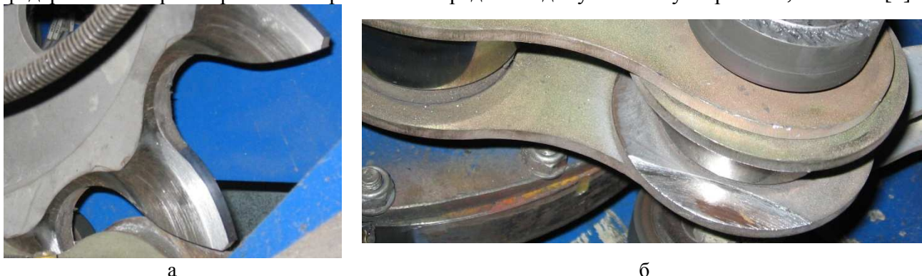
Рис. 2. Примеры характерного износа: а – зубьев звездочек; б – звеньев тяговых цепей эскалатора
