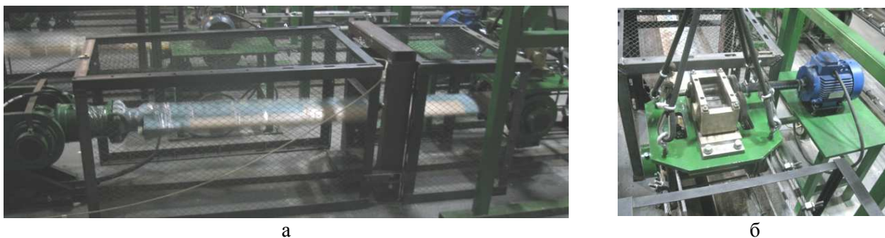
Рис. 1. «Стандартный» вибрационный испытательный стенд: а – фрагмент лопасти вертолета в состоянии вибрационного нагружения; б – вибрационный возбудитель колебаний
