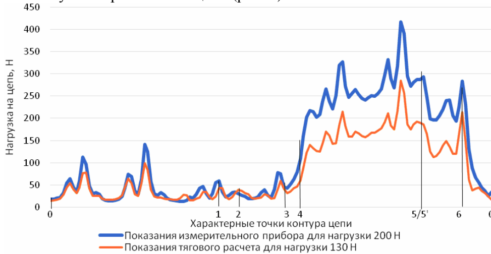
Рис. 5. График нагруженности цепи по контуру цепи
