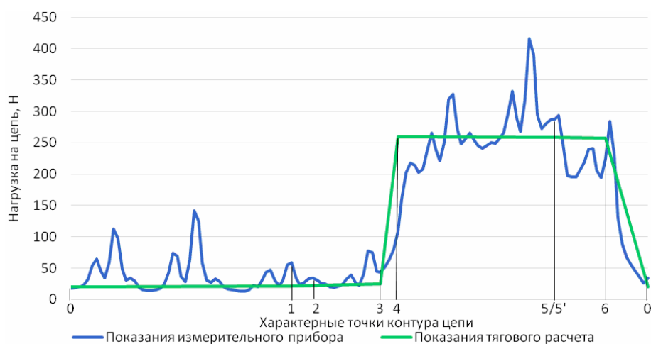
Рис. 7. Результаты тягового расчета и экспериментальных исследований по контуру цепи при нагрузке 200 Н на приводной ролик
