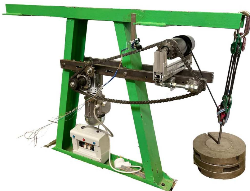
Рис. 2. Общий вид испытательного стенда для измерения деформаций цепи
