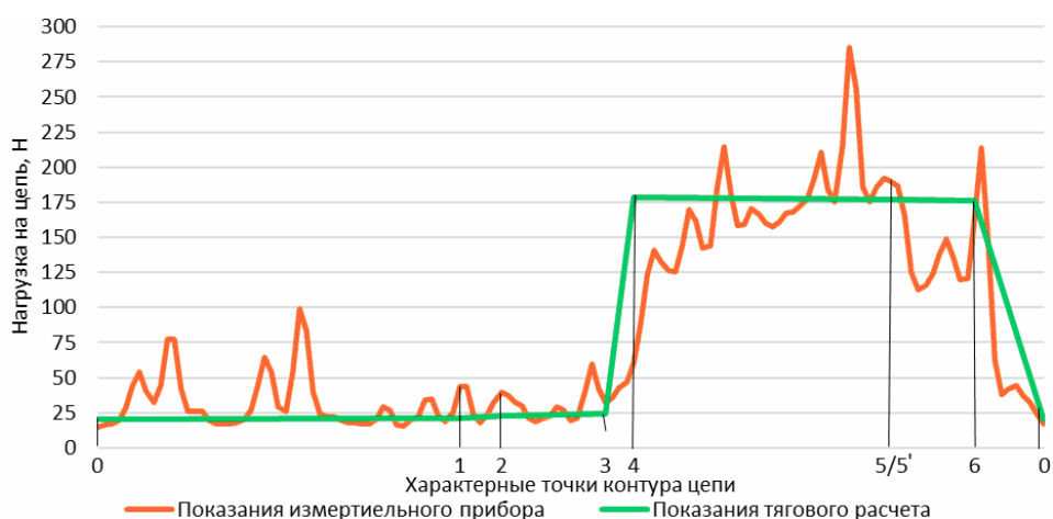
Рис. 6. Результаты тягового расчета и экспериментальных исследований по контуру цепи при нагрузке 130 Н на приводной ролик
