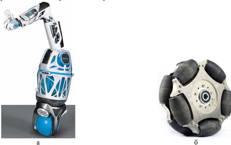
Рис. 1. Робот, состоящий из платформы с омни-колесами, балансирующей на сферическом колесе: а) пример робота; б) омни-колесо
