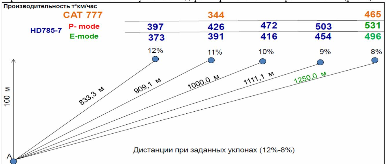
Рис. 5. Моделирование производительности в зависимости от уклона
