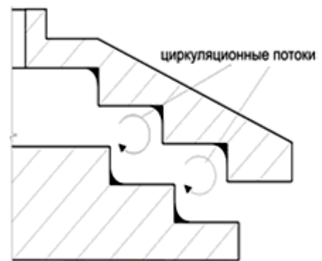
Рис. 5. Схема циркулирующих потоков в рабочей камере
