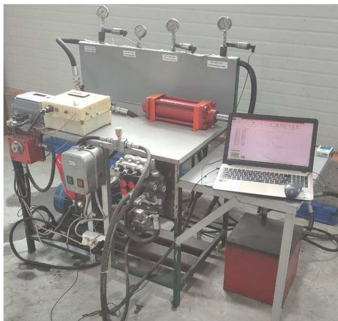
Рис. 2. Фотография стенда для исследования закрытой гидропередачи с аккумуляторным поддержанием избыточного давления во всасывающей линии насоса
