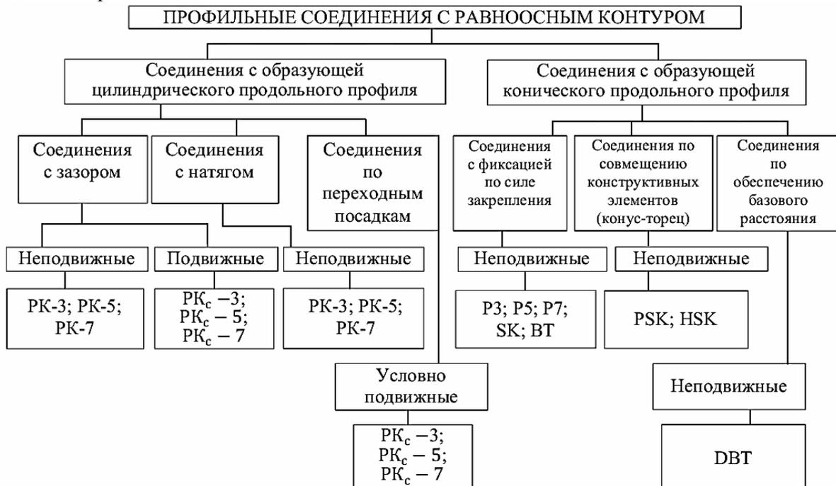
Рис. 1. Классификация моментопередающих соединений с равноосным контуром
