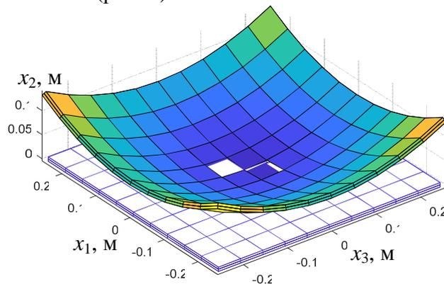
Рис. 3. Начальное искомое (верхняя пластина) и конечное (нагруженная нижняя пластина) состояния упругого тела
