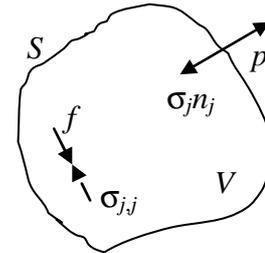
Рис. 1. Иллюстрация уравнений статической краевой задачи; в любой точке внутри объема  $V$  и на поверхности  $S$  тела внешние силы уравновешены внутренними напряжениями;  $\sigma_j$  – вектор напряжения на площадке с нормалью  $n_j$
