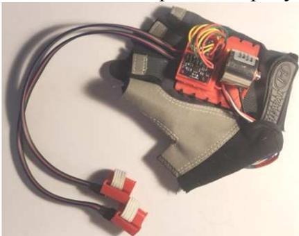
Рис. 2. Перчатка для считывания движений
