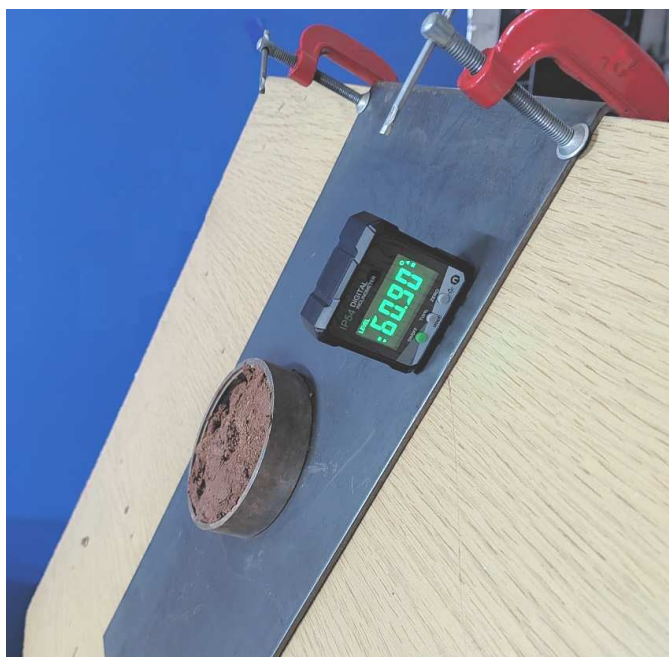
Рис. 3. Рабочая поверхность при определении угла внешнего трения грунта
