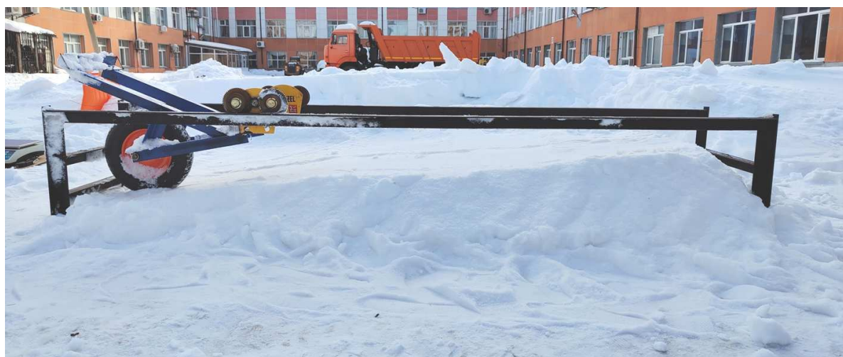
Рис. 4. Лабораторная установка со сформированной снежной массой требуемой толщины
