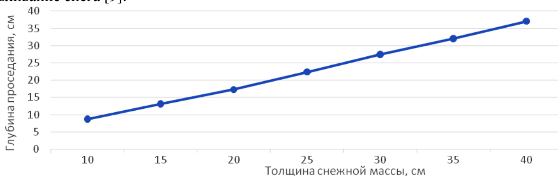
Рис. 6. Влияние толщины снежной массы на глубину проседания штампа
