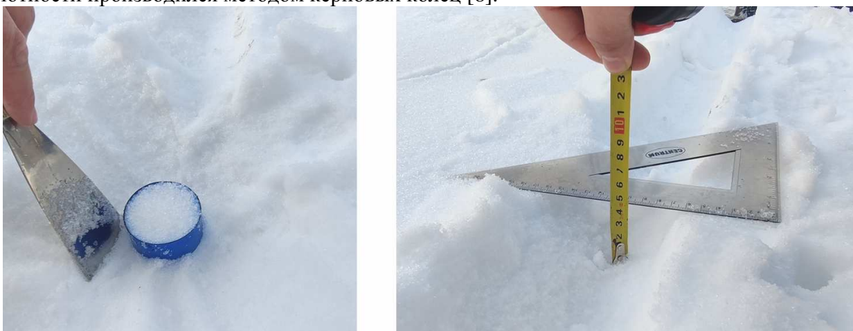
Рис. 5. Замер показателей после прохождения шины лабораторной установки
