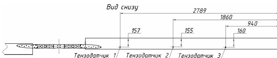
Рис. 3. Схема установки тензодатчиков
