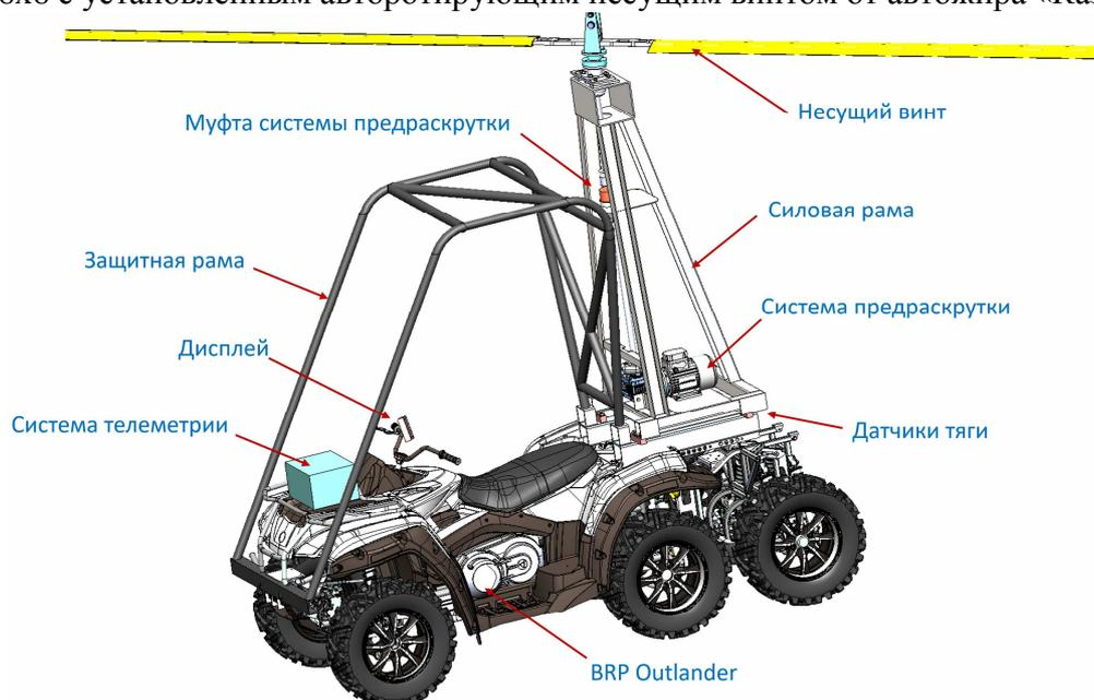
Рис. 1. Общий вид специализированного стенда
