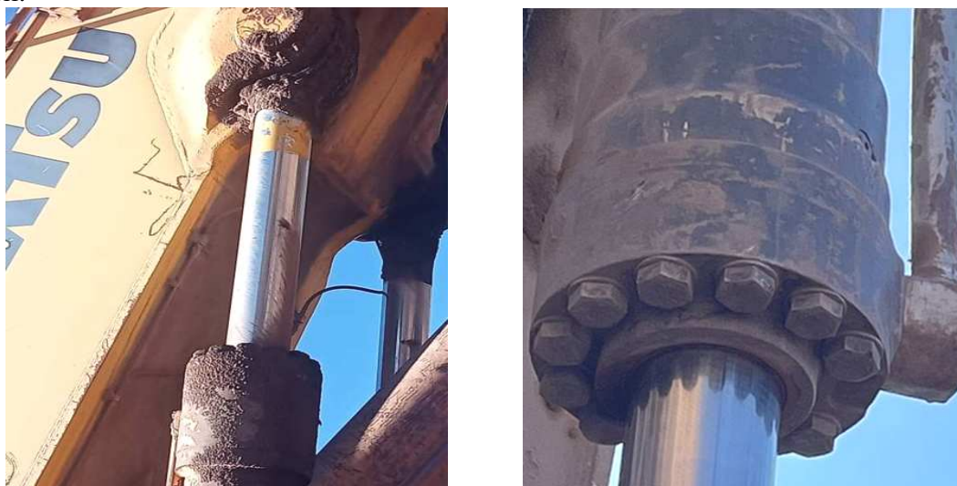
Рис. 2. Состояние гидроцилиндров экскаваторов Komatsu PC1250-7 и Liebherr R9100 G6 на руднике Бухадра
