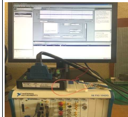
Рис. 4. Процессор и датчик DAQ Signal Accessory от фирмы National Instruments (NI)
