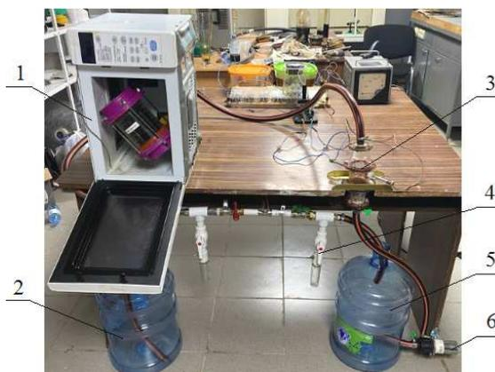
Рис. 5. Лабораторный стенд для обработки водонефтяной эмульсии: 1 – СВЧ-реактор; 2 – ёмкость для отработанного нефтешлама; 3 – ЭГР по эффекту Юткина; 4 – пробоотборник; 5 – ёмкость для нефтешлама; 6 – насос
