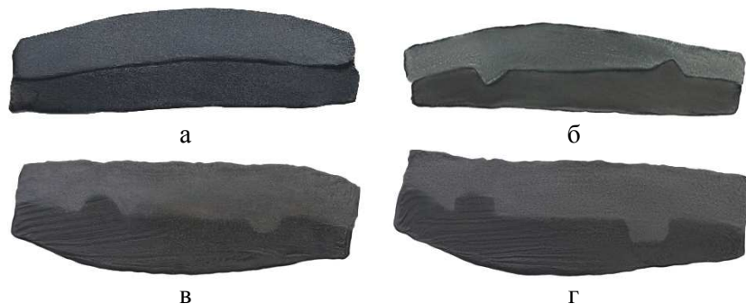
Рис. 6. Заготовки образцов: а – без зубца; б – с зубцом треугольной формы; в – с зубцом полукруглой формы; г – с зубцом квадратной формы
