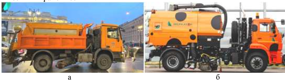
Рис. 1. Коммунальные машины: а) с плужным снегоочистителем, цилиндрической щеткой и разбрасывателем реагента; б) с вакуумной подметально-уборочной установкой
