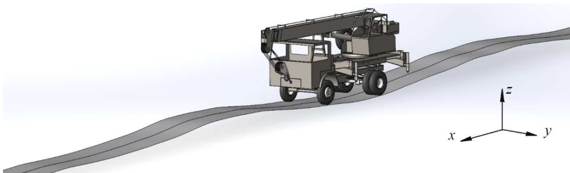
Рис. 6. Трехмерная модель автомобильного крана КС-35715 на сформированной поверхности разбитой грунтовой дороги
