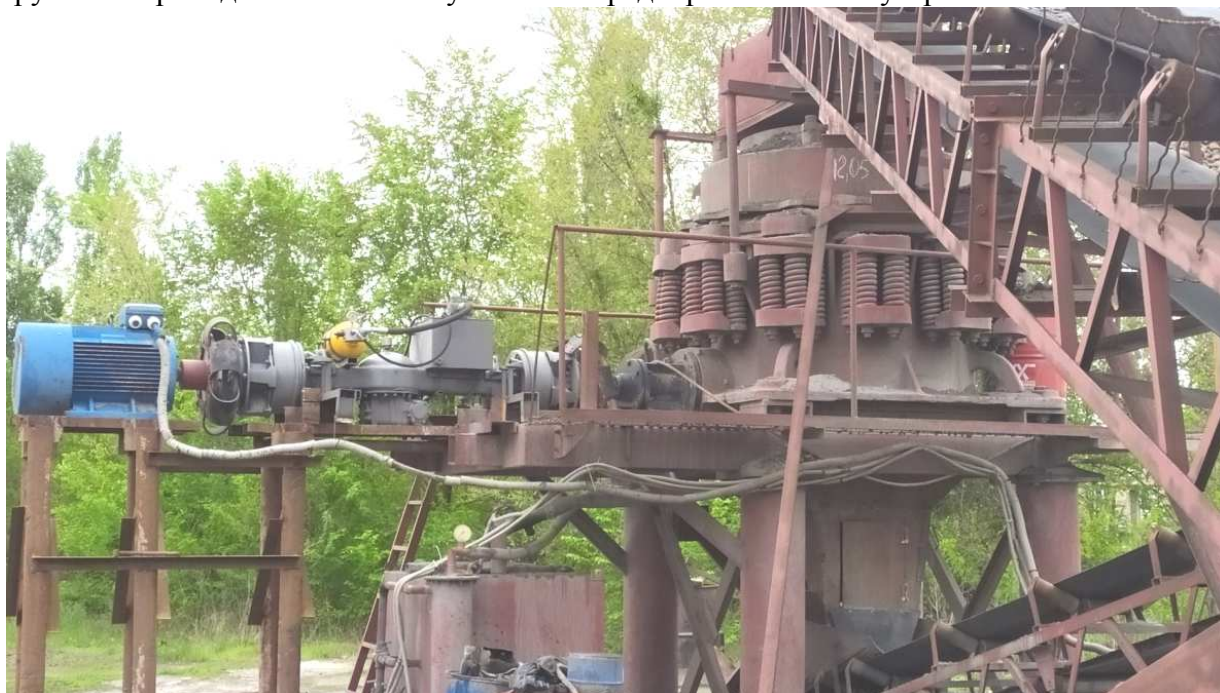
Рис. 4. Установка опытного образца в привод дробилки
