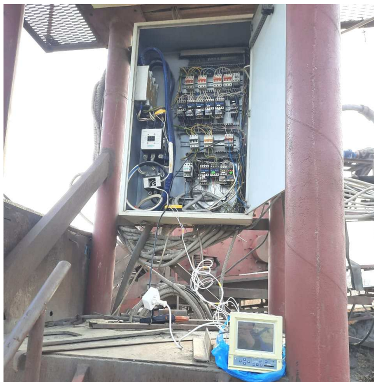
Рис. 2. Подключение измерительного устройства PMT 69L
