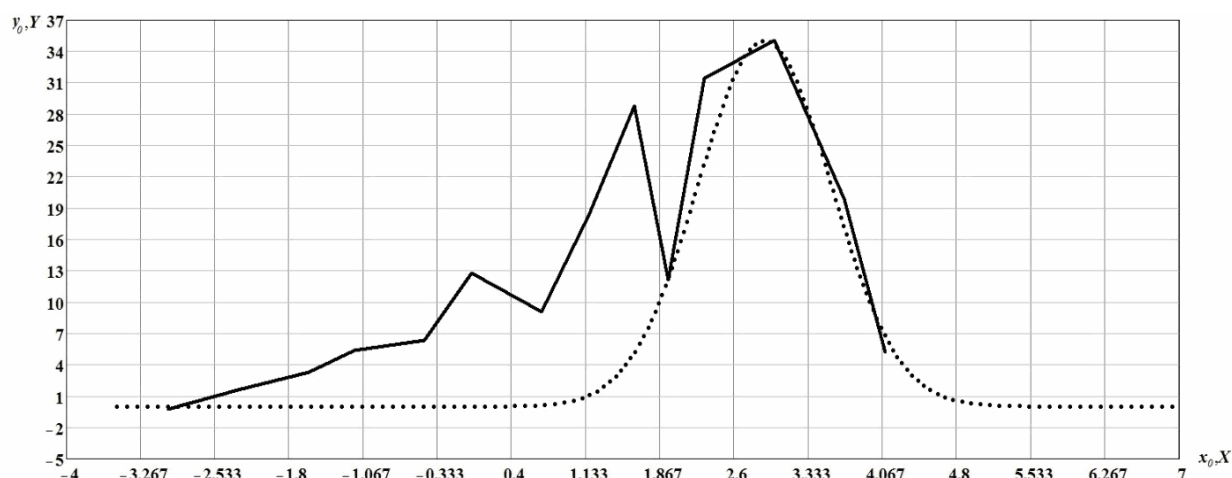
Рис. 4. Определение степени дезинтеграции в дробилке ДКД-300 кварцевой руды месторождения Дуэтское
