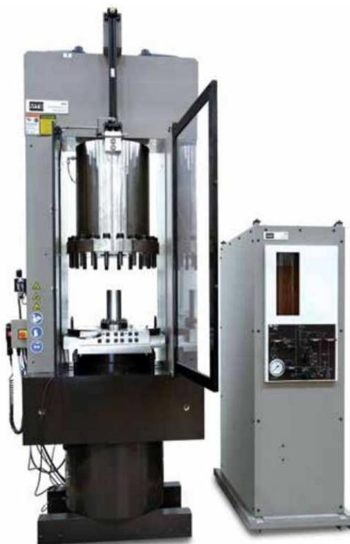
Рис. 3. Общий вид универсальной сервогидравлической испытательной машины MTS Model 815
