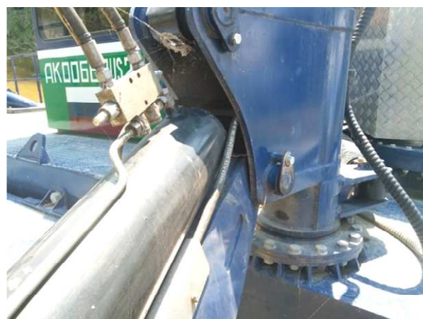
Рис. 5. Повреждения проушины гидроцилиндра
